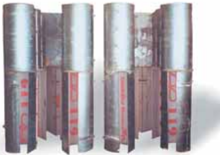
Трубы циклона в вентиляционной системе эксгаустера. Тепловая электростанция
