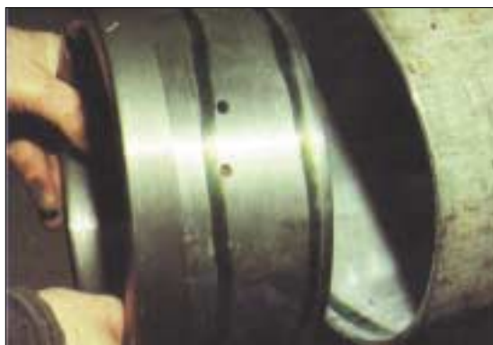
Теперь стальная оконечная муфта крепится с помощью клеящего состава Loctite 638. Больше не требуется нарезать ни внутреннюю, ни внешнюю резьбу на втулке.
