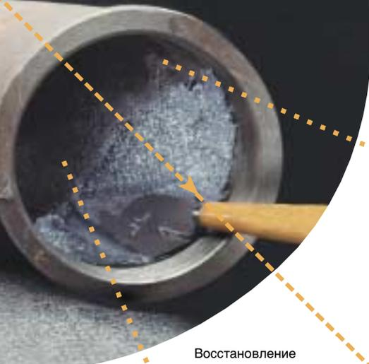
Восстановление эрозионно изношенного колена с помощью композиции Loctite 7218
